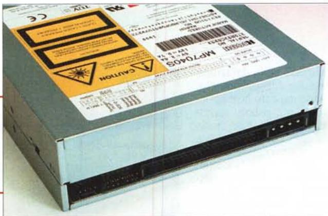
Sul pannello posteriore troviamo il classico connettore a cinquanta pin per il collegamento al controller SCSI-2, con i ponticelli per la scelta dell'ID e per l'abilitazione del terminatore.
