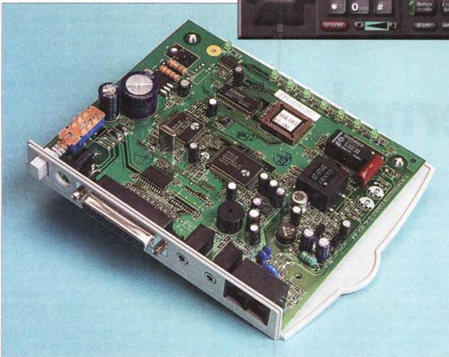
Internamente un'unica piastra di circuito stampato supporta tutti i componenti elettronici, anche la flash eprom riprogrammabile che contiene il firmware del dispositivo. Sul pannello posteriore, oltre alle canniche connessioni per un modem, troviamo anche il pulsante di accensione e le prese audio per microfono e altoparlanti esterni.
