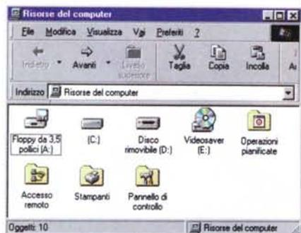
Nella finestra Gestione Risorse si possono notare, una volta installato il dispositivo, due diverse icone, una che rappresenta un hard disk rimovibile e l'altra un lettore di CD. In realtà queste due icone sono collegate allo stesso dispositivo DVD-RAM, ma sono attive alternativamente se utilizziamo una cartuccia riscrivibile oppure un disco CD, CD-ROM o DVD-ROM.
