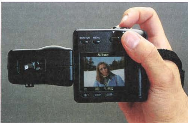
Il display LCD può essere utilizzato sia come mirino elettronico sia per visualizzare le immagini registrate in memoria.
