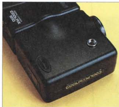
L'ingresso per l'alimentatore esterno, l'uscita video PAL, l'alloggiamento per la Compact Flash (8MB standard). A destra, sul fondo della macchina, la regolazione diottrica del mirino e il contatto per il flash TTL esterno.
