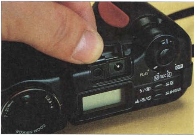
L'ingresso per l'alimentatore esterno, l'uscita video PAL, l'alloggiamento per la Compact Flash (8MB standard). A destra, sul fondo della macchina, la regolazione diottrica del mirino e il contatto per il flash TTL esterno.
