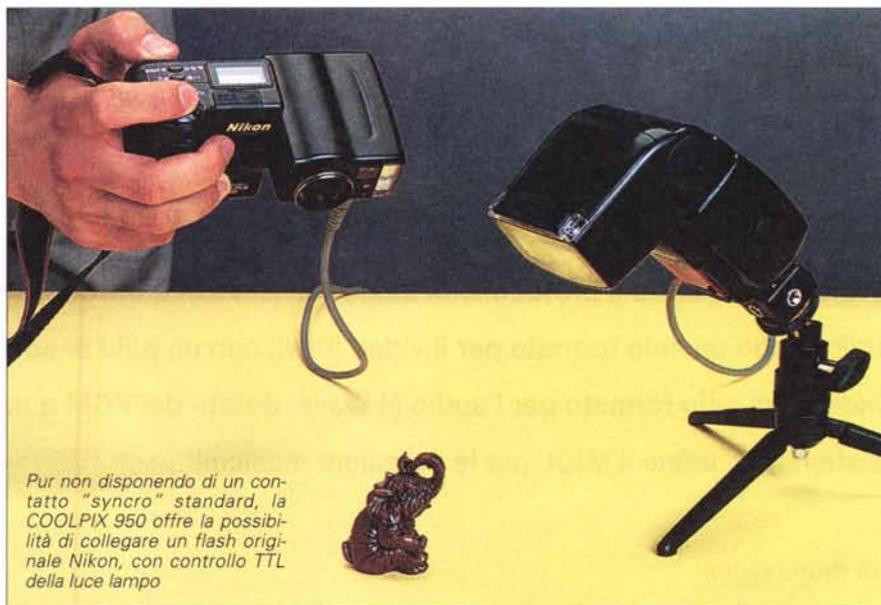
*Pur non disponendo di un contatto "syncro" standard, la COOLPIX 950 offre la possibilità di collegare un flash originale Nikon, con controllo TTL della luce lampo*
