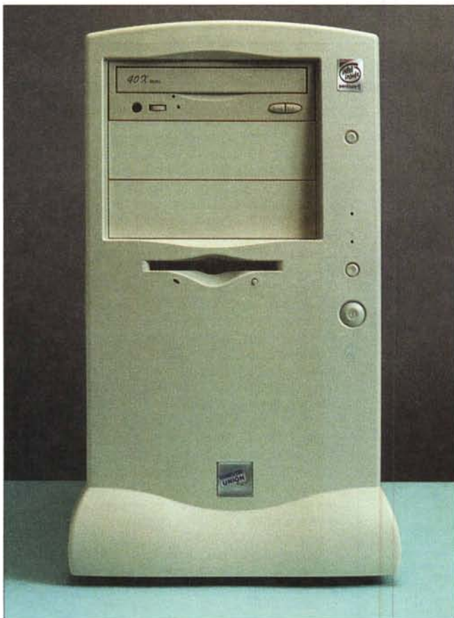
Il mobile di questo computer è un minitower non molto mini, non tanto per l'altezza quanto per la larghezza di circa cinque centimetri maggiore di quella dei cabinet tradizionali.
