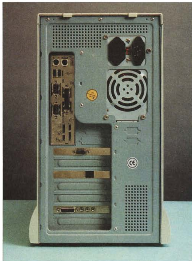
Sul pannello posteriore troviamo tutte le porte previste dallo standard ATX, oltre all'uscita VGA, alla presa del modem interno ed alle connessioni della scheda audio.
