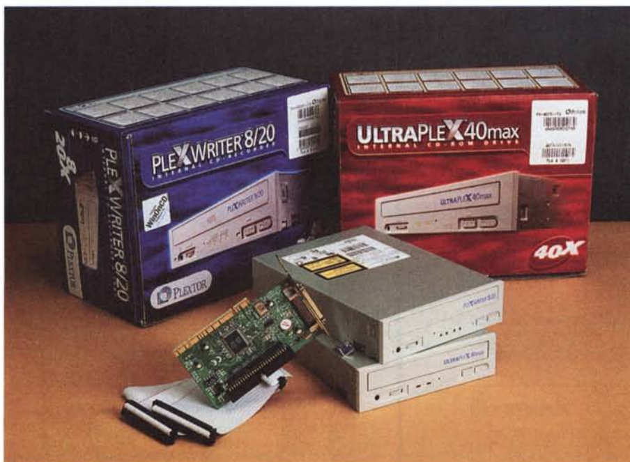
Per realizzare una catena SCSI adatta alla masterizzazione di CD-R è sufficiente utilizzare controller relativamente economici come l'Adaptec AVA 2904CD oppure l'IOI-4201. Le loro prestazioni sono eccellenti le necessità e il loro costo ampiamente abbordabile. In più è possibile connettere alla medesima "catena" altre periferiche SCSI come scanner, dispositivi magneto-ottici, Zip...
