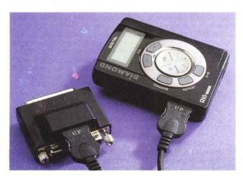
Il cavo di connessione con il computer assomiglia molto a quelli utilizzati nei telefonini, a causa del connettore multipolare extrapiatto.
