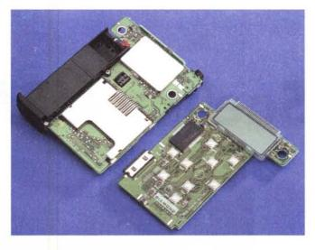
La costruzione interna è eccezionale: in due schedine di circuito stampato disposte a sandwich, poco più grandi di una carta di credito, troviamo una quantità impressionante di componenti SMD e di circuiti integrati VLSI. Su una delle schedine troneggia lo slot per l'inserimento della scheda di espansione di memoria.
