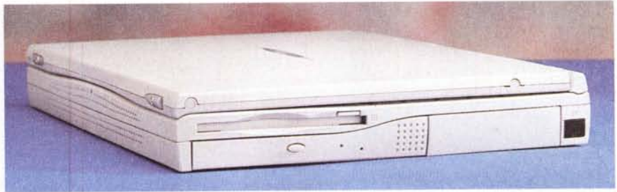
Sul lato destro trovano agevole collocazione sia il lettore dei floppy disc che quello dei CD-ROM. Accanto ad essi lo sportello che nasconde l'hard disk e, nell'angolo, la finestrella dell'interfaccia a raggi infrarossi.
