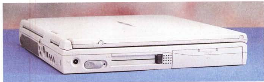
Il lato sinistro del computer con il grande pulsante di accensione colore argento, i due slot PCMCIA e il vano batteria.
