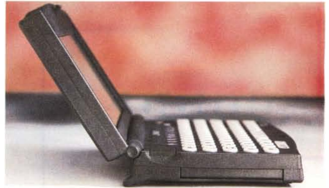
Due viste laterali del Compaq 2000c. Sul lato destro troviamo la seriale e l'alimentazione, sulla sinistra lo slot PCMCIA.
