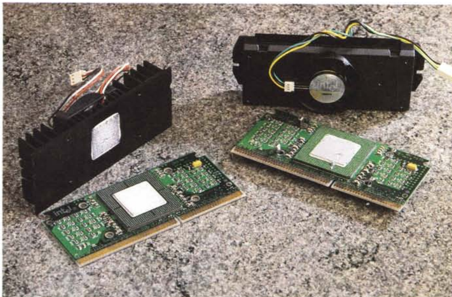
La differenza fra un Mendocino 300 e un Pentium II 450 è dimensionalmente evidente. Viceversa le prestazioni del piccolo portato a 450 MHz sono estremamente vicine a quelle del Pentium II 450.
