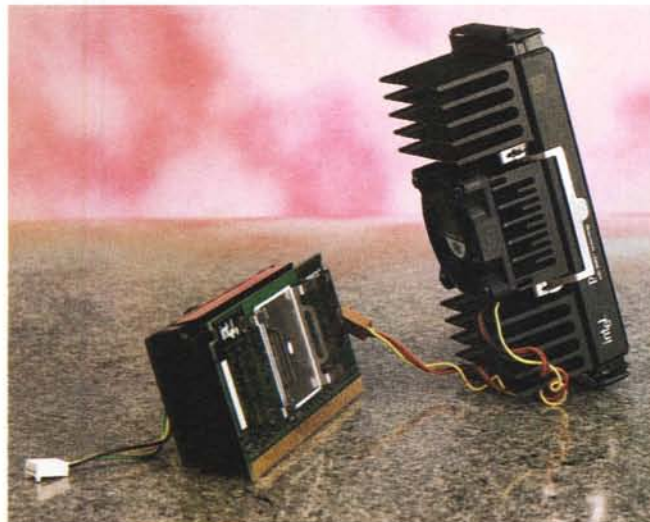
Ovviamente la versione del Celeron A OEM ha necessità di un dissipatore da acquistare separatamente. Essenziale è la presenza di pasta termo-conduttrice fra cpu e dissipatore per abbassare la resistenza termica. È una accortezza comunque necessaria viepiù indispensabile nel caso di overclocking a 450 MHz. Ovviamente la versione Retail utilizza una pasta conduttrice di ottima qualità.
