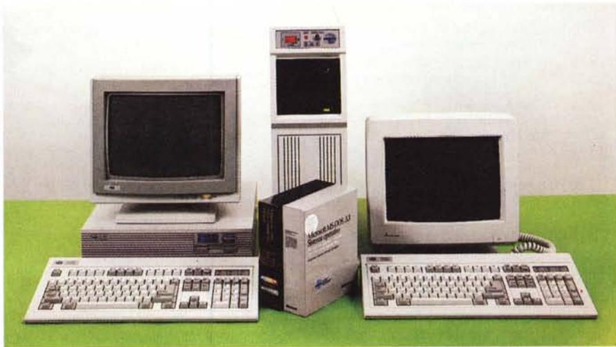
Nel 1989 circolavano ancora liberamente i 286, seppur in via d'estinzione. L'Unidata PX-6047, provato assieme al fratello maggiore AX-80B7, era uno di questi. Processore a 18 MHz, mezzo megabyte di RAM, un hard disk da 40 MB per appena... 4.400.000 lire, ovviamente IVA esclusa. Il maggiore, basato sul più performante 386, costava addirittura il doppio. Che tempi!
