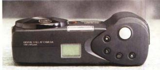
La parte superiore è quella che assomiglia di più a quella di una macchina fotografica tradizionale. Nel piccolo display sono riportate alcune funzioni della fotocamera, come numero delle foto rimanenti, qualità impostata, modalità del flash e stato delle pile. I tastini a destra, oltre il pulsante di scatto, servono per settare la qualità delle foto, il flash, l'autoscatto e la modalità macro.
