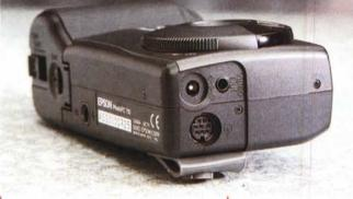
Le prese per il collegamento al mondo esterno si trovano ben protette da un coperchietto in gomma. Notiamo la presa per l'alimentatore esterno (non fornito), l'uscita per TV e il con-nettore MiniDIN della seriale veloce per il collegamento con il computer.
