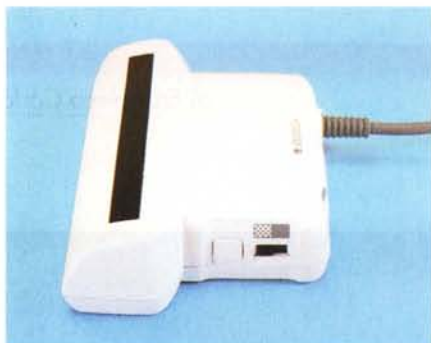
Lo Scanman di Logitech; quanti ce ne sono ancora in giro, a fare onestamente il loro dovere! Caratteristica la tendenza a deformare le immagini in senso verticale, con le facce a "testa d'uovo"
