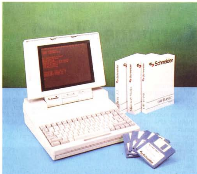
Schneider, chi era costui? Uno strano portatile, che però si alimenta solo dalla rete, con il cuore di un 286 e un avveniristico (e costoso) schermo al plasma.
