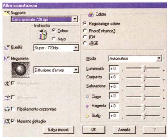
Figura 2 - Le altre impostazioni servono a personalizzare i parametri di stampa per ottenere il risultato finale della qualità cercata, compatibilmente con il supporto utilizzato.
