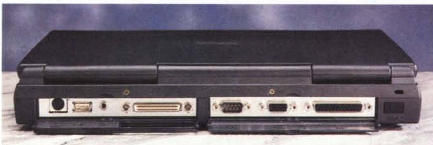
Protette da sportello le uscite posteriori, sia quelle classiche che la nuova utilissima USB.
