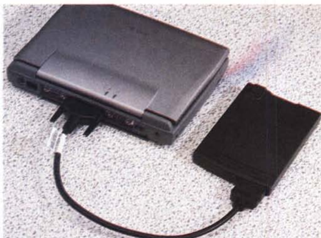
L'unità floppy disk si collega tramite porta parallela, il lettore di CD-ROM utilizza una propria interfaccia in formato PCMCIA e un proprio alimentatore separato.
