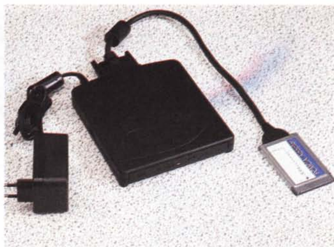
L'unità floppy disk si collega tramite porta parallela, il lettore di CD-ROM utilizza una propria interfaccia in formato PCMCIA e un proprio alimentatore separato.
