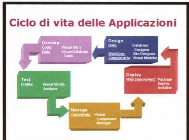
Figura 3 - MS Visual Studio 6.0 - Il ciclo di vita del software. I vari tool disponibili nel pacchetto Visual Studio consentono di seguire l'intero ciclo di vita dell'applicazione software che si sta realizzando. Vita che va dall'idea iniziale dell'applicazione alla sua schematizzazione in un modello, alla progettazione dei suoi componenti, alla loro realizzazione "fisica", all'assemblaggio, ai vari test di funzionamento. Il ciclo di vita del software continua anche dopo il rilascio dell'applicazione in quanto sono previste fasi di monitoraggio del funzionamento e delle prestazioni e poi, via via che ne nasce la necessità, le successive modifiche ai programmi.
