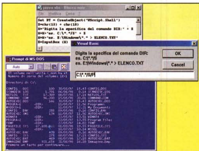
Figura 6 - Windows Scripting Host - MS-DOS: il ritorno Questa figura mostra un esempio molto semplice di come WSH possa servire anche da interfaccia grafica per operazioni da eseguire nella finestra Prompt di MS-DOS. Ad esempio se vogliamo visualizzare una directory nella finestra DOS possiamo usare questo piccolo programma al quale passiamo, con una istruzione InputBox, la specifica da attribuire al comando DIR. Il programma può servire anche per stampare l'output o per riversarlo su file, utilizzando le numerose specifiche permesse dal vecchio, indimenticabile (anche nel senso che è meglio non dimenticarlo) DOS.
