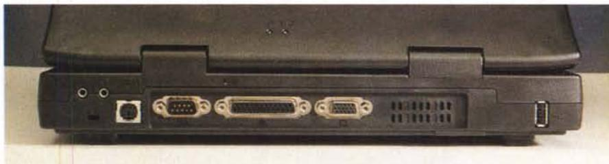
Sul retro, da sinistra a destra, i due mini-jack audio, il kensington lock, la porta PS/2, la porta seriale, quella parallela, la porta per un monitor esterno ed infine la seriale USB.
