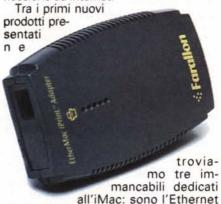
iPrint Adapter SL, che permette di collegare le normali stampanti Apple StyleWriter seriali all'iMac attraverso la porta di rete Ethernet; l'iPrint Adapter LocalTalk con cui invece ogni iMac potrà essere collegato, sempre attraverso l'interfaccia Ethernet, a una normale rete LocalTalk a doppino telefonico; e l'ultimo, l'hub Fast Starlet dual speed, molto comodo per integrare il nuovo Macintosh, che è dotato di porta Fast Ethernet, con reti 10BaseT; l'hub è dotato di 8 porte 10/100 autosensing
