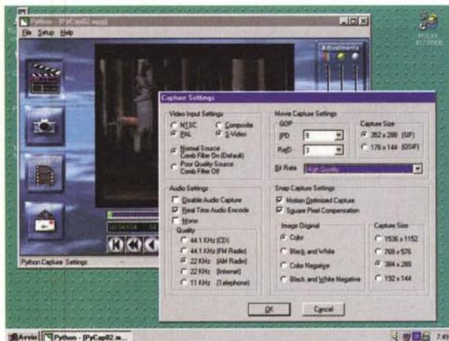
Il Capture Setting è senz'altro più complesso, potendo agire su parametri come i segnali di ingresso (composito e S-VHS), l'inserimento di un "comb filter", i settaggi GOP, tra Intraframe e Reference Frame, il bit rate, la parte audio ecc. per ottimizzare al massimo l'efficienza della compressione.
