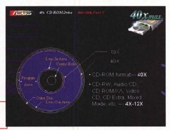
Schema relativo alle modalità di lettura di un'unità "max" rispetto alla disposizione dei dati.
