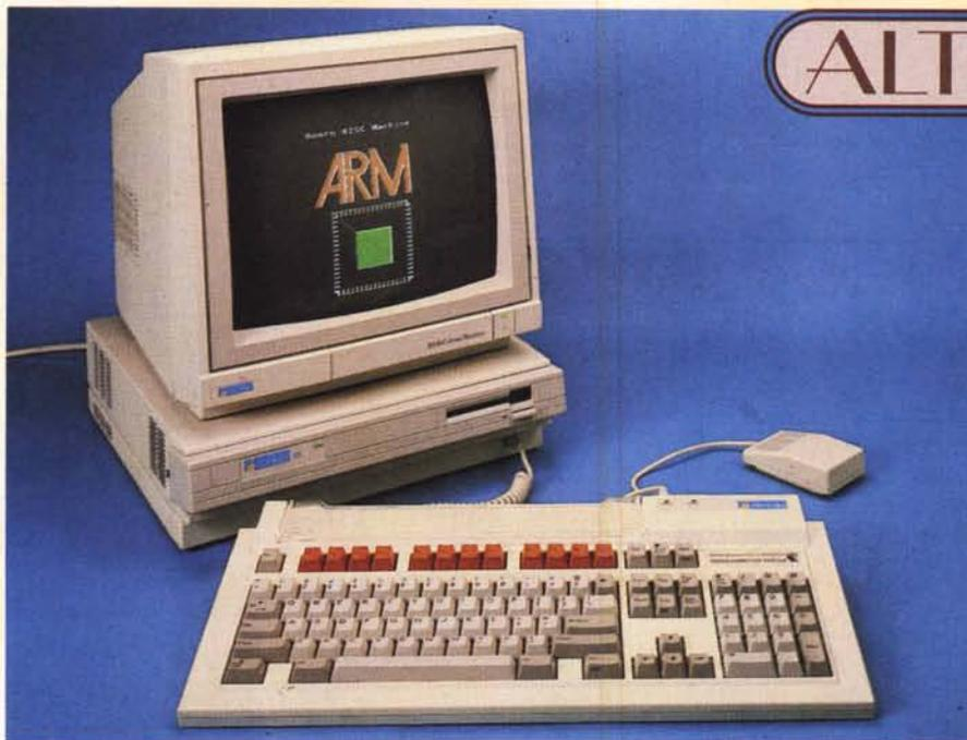
L'Acorn Archimedes fu il primo personal computer basato su un microprocessore RISC (Reduced Instruction Set Computer), in grado cioè di elaborare molto rapidamente istruzioni macchina semplici. Non ebbe vita facile, ma non per questo non contò a lungo su una nutrita schiera di estimatori (se non, addirittura, veri e propri fan).
