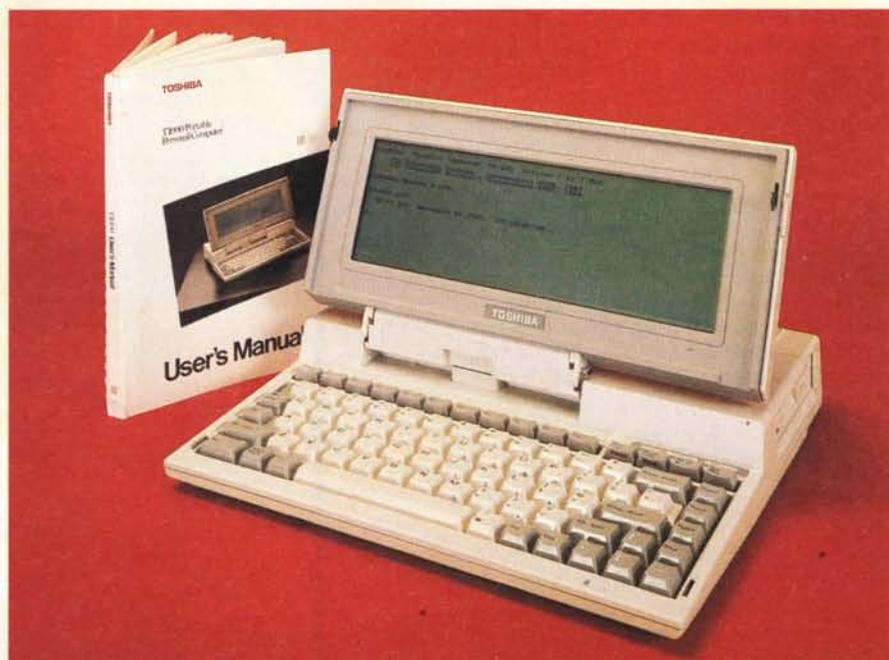
*Più tradizionale per forma e dimensioni, il Toshiba T1000 rappresentava una valida alternativa economica per il mobile computing dell'epoca. Display CGA non retroilluminato, processore "basico" 8088 a 4,77 MHz (come il primo PC IBM), in versione CMOS, niente hard disk e soli 512 K di memoria RAM. Era però molto compatto e si faceva trasportare senza tanta fatica.*
