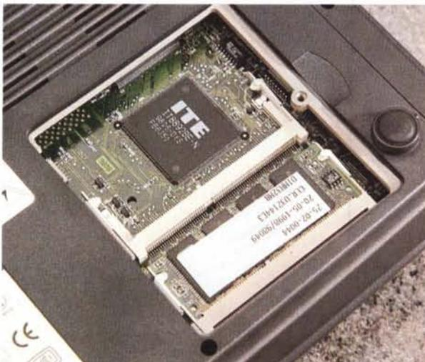
Due i banchi per la RAM che possono contenere ciascuno un modulo DIMM da 32 MB.
