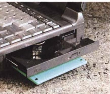
Sul lato destro si trovano il vano batteria e il blocco CD-ROM/floppy.
