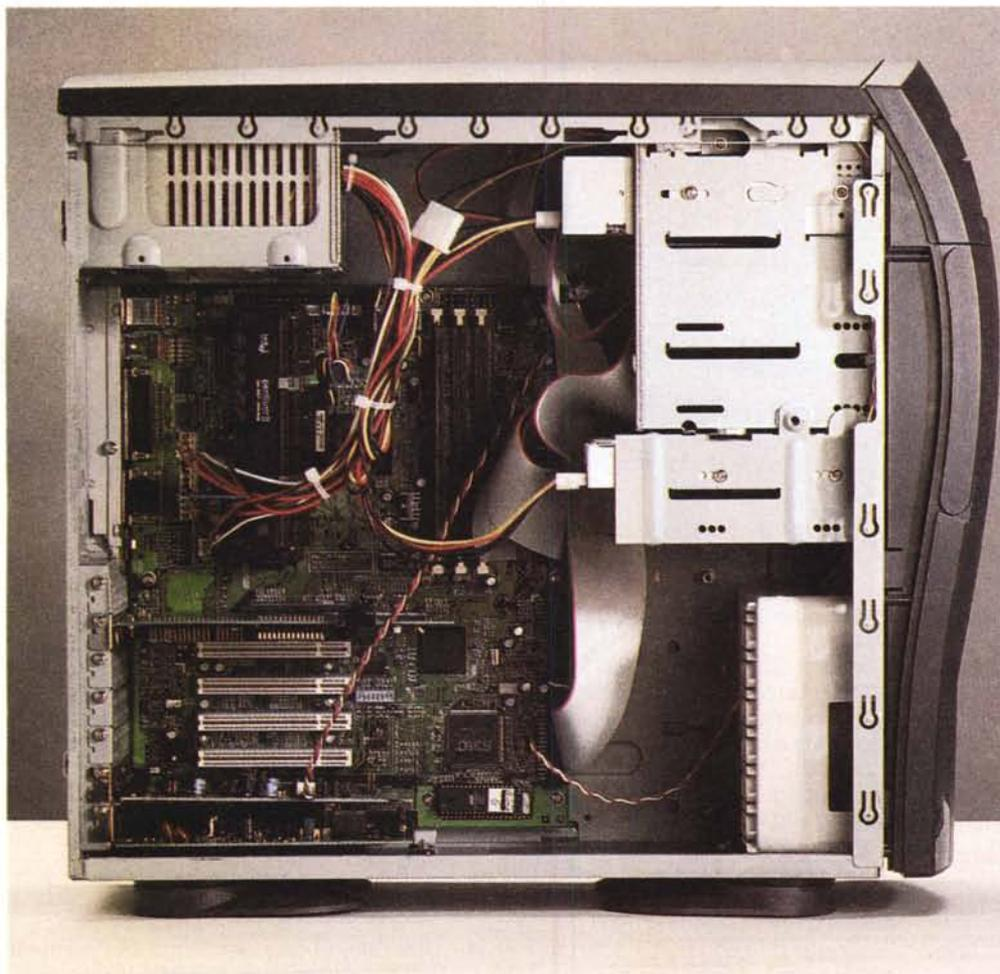
*Vista d'interno dell'Aspire. Posizionati in alto ai due lati estremi del cabinet sia il blocco dell'alimentazione che il cestello delle periferiche, il resto del vano-componenti risulta particolarmente spazioso. Al riguardo vanno notate anche le quattro slot PCI ancora a completa disposizione dell'utente.*
