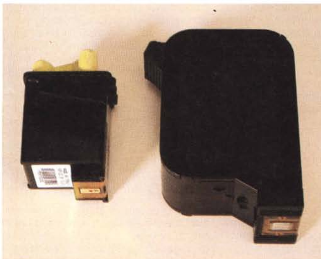
A sinistra confronto dimensionale tra la testina di stampa HP e quella Olivetti Lexicon. A destra la testina Canon con le due cartucce separate per i colori e il nero.
