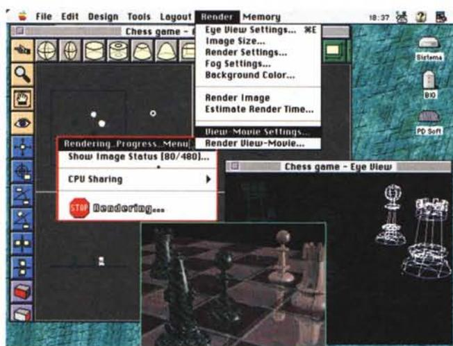
stesso vale per le texture e le sorgenti di luce. A questo punto, in un solo passaggio, è possibile generare l'immagine foto-realistica con il classico algoritmo del ray tracing. Si può controllare l'ombra, la granulosità, la rifrazione e la riflessione; ci sono a disposizione sorgenti di luce spot e diffuse, inoltre è possibile applicare anche un algoritmo di nebbia regolabile in densità e
