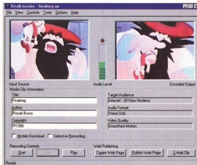
Figura 7 - Real Encoder. Il modulo di codifica durante una fase di lavoro. Il file che stiamo trattando con il template da 28.8 Kbps è già stato acquisito e compresso in hardware da Indeo 3.2.
