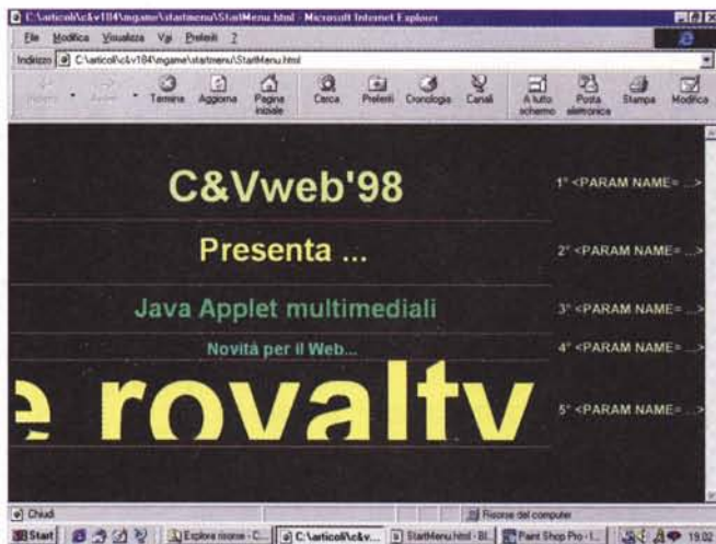
Figura 15 - Cinque dei sei <PARAM NAME= ...> che l'applet Start Menu ci mette a disposizione per scrivere delle titolazioni. Ogni singolo "param" può anche fare riferimento ad un link verso una specifica URL.
