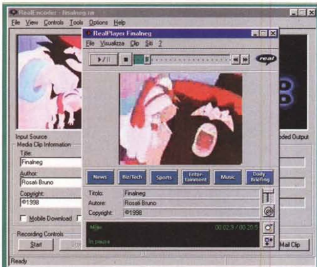
Figura 8 - Real Encoder. Una volta terminata la fase di codifica, premendo sul bottone Play potremo far eseguire dal RealPlayer lo streaming appena realizzato. Quanto è possibile vedere in questa immagine dimostra come, ricomprimendo su di un file già precedente trattato in compressione (l'esempio è relativo ad un filmato precedentemente trattato con Indeo 3.2) il RealEncoder non può che operare un pesante degrado della qualità.
