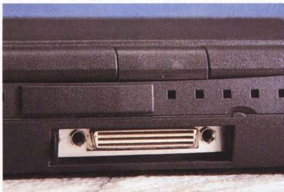
Sul retro della macchina, a parte le consuete connessioni (seriale, parallela, SVGA) troviamo una comoda porta USB, un'interfaccia a raggi infrarossi e (in basso) un connettore per la MiniDock opzionale.
