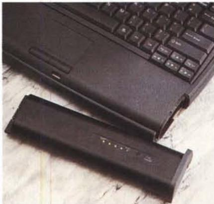
I LED di monitoraggio sulla batteria ricaricabile.
