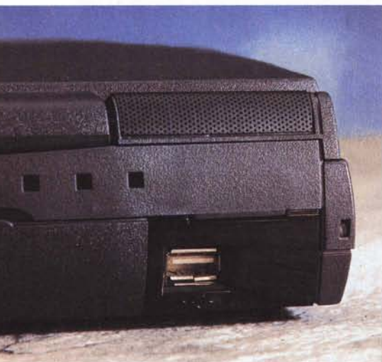
Sul retro della macchina, a parte le consuete connessioni (seriale, parallela, SVGA) troviamo una comoda porta USB, un'interfaccia a raggi infrarossi e (in basso) un connettore per la MiniDock opzionale.
