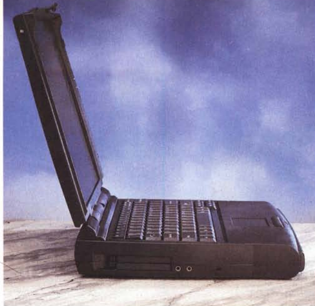
Le dimensioni del TravelMate 7300, considerata la presenza di un display TFT da 13.3" non sono certo contenute. Sul lato sinistro troviamo il doppio alloggiamento PCMCIA.
