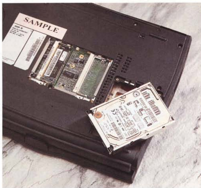
Signore e signori, abbiamo il piacere di mostrarvi in assoluta anteprima il Pentium II Mobile a 266 MHz (standing ovation...), testé strappato al TravelMate. In alto l'alloggiamento per l'hard disk rimovibile e per l'espansione di memoria.
