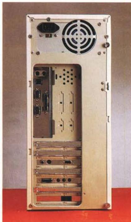
Il retro del PC. Oltre a quelle dell'I/O in standard ATX sono da notare, sulle barre d'espansione, le connessioni relative alla scheda video (con tre differenti output: S-VGA, composito e S-Video), quelle della scheda audio (il connettore MIDI/joystick, l'ingresso microfonico e l'I/O via linea. Infine i connettori del modem).
