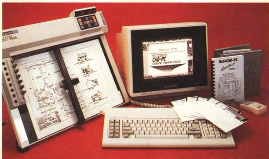
RoboCad-PC era un sistema completo per la produzione di disegni tecnici bidimensionali per svariati campi d'applicazione. Nella foto è visibile anche il plotter a colori, otto penne, Roland DXY 980A.
