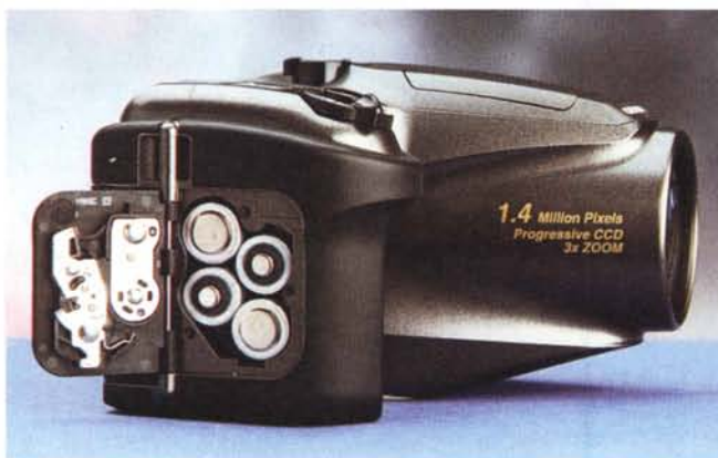
Per l'alimentazione della fotocamera si utilizzano quattro comunissime pile stilo o le "capienti" ricaricabili da 1.3 Ah (!!!) fornite a corredo assieme al caricabatterie.
