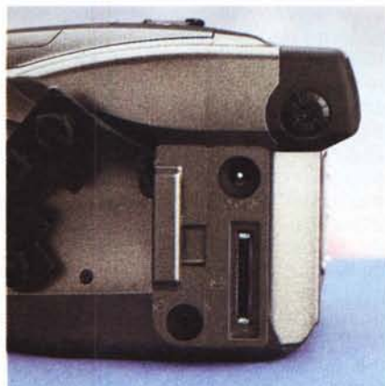
Sul lato sinistro, protette da uno sportellino in gomma morbida, le connessioni per l'esterno.
