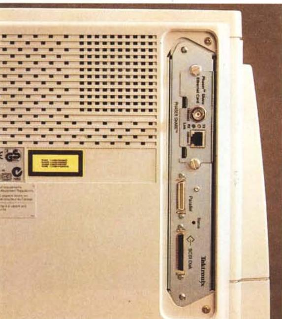
Il pannello dell'I/O si compone di una parte fissa con la presa parallela e la SCSI per l'hard disk esterno e di un cassetto intercambiabile con le prese per la rete.
