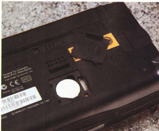
Nell'alloggiamento per la pila di backup "salva-memoria", troviamo anche un pulsantino di reset per risolvere, con le maniere forti, eventuali problemi essenziali di Windows CE. Naturalmente tutti i file salvati, nonostante siano in RAM, non vengono cancellati in seguito al reset.
