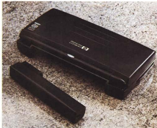
La batteria ricaricabile è del tipo agli Ioni di Litio, senza effetto memoria e dal peso molto contenuto. Permette un'autonomia di utilizzo di due o tre ore. Opzionalmente è disponibile una batteria di capacità doppia che deborda posteriormente facendo lievitare ulteriormente, oltre al peso, le dimensioni complessive del super-palmtop.
