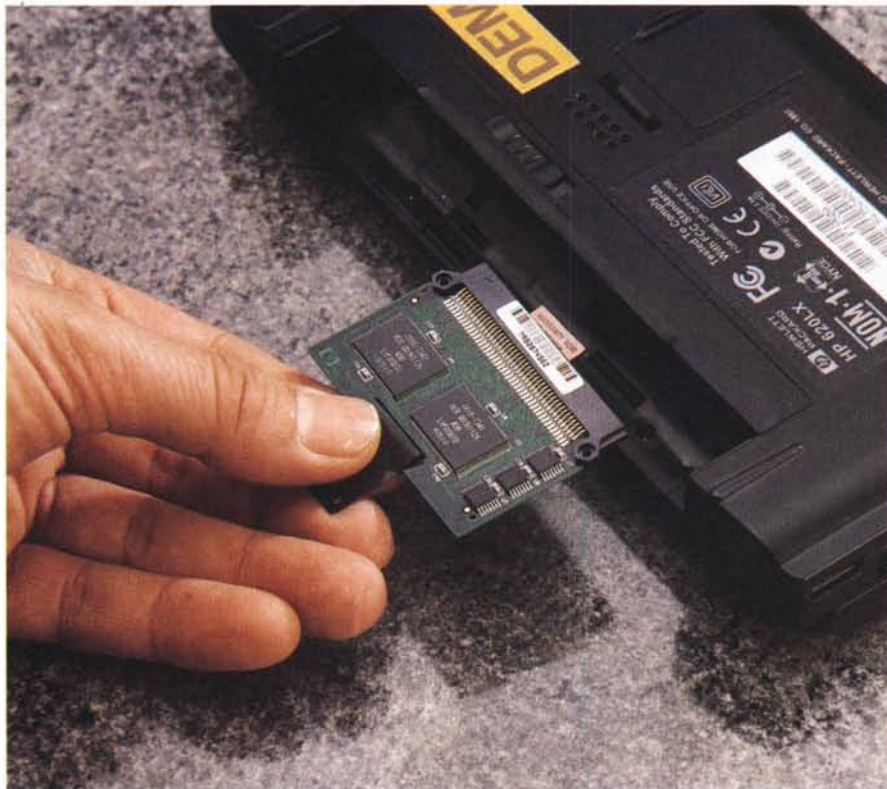
All'interno dell'alloggiamento per la batteria ricaricabile troviamo... il sistema operativo della macchina sotto forma di scheda ROM. L'upgrade del firmware, non appena disponibile, sarà ultrasemplificato.
