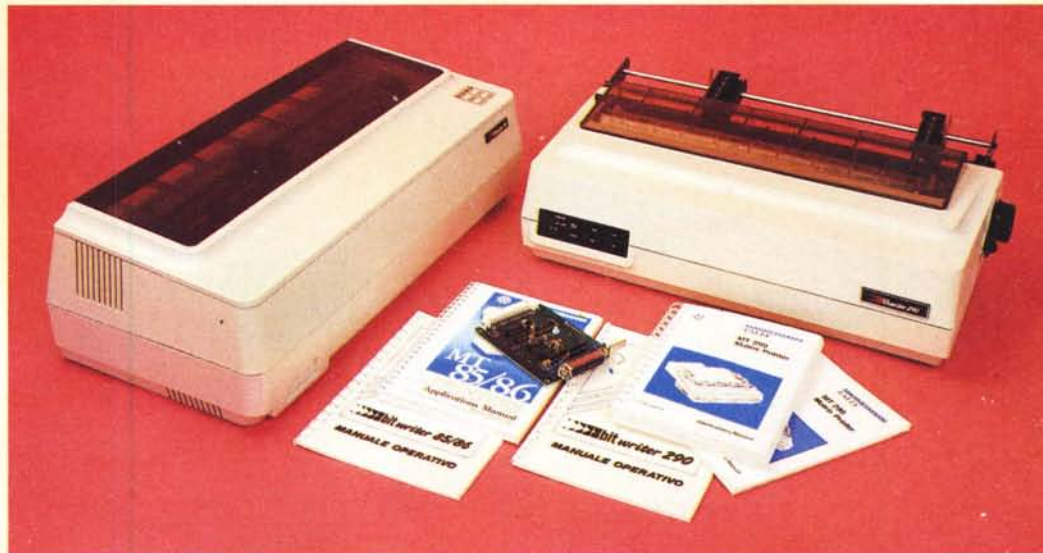
Due stampanti ad aghi per utilizzo esclusivamente professionale: Bitwriter (Mannesmann) MT86 e MT290.
