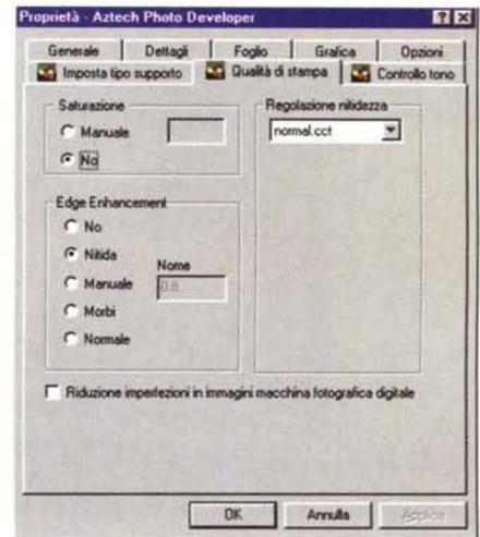
Figura 3. Il driver di stampa del DPD-200 permette di modificare alcuni parametri quali la saturazione del colore, il contrasto ai bordi dell'immagine e la possibilità di elaborare le immagini ottenute da fotocamere digitali per aumentarne la qualità.
