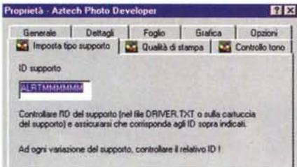
Figura 2. Operazione importante all'atto dell'inserimento della cartuccia contenente i supporti è l'inserimento del codice relativo al film utilizzato. Questo codice probabilmente permette di tarare l'esposizione sulle caratteristiche di sensibilità ai vari colori propri del lotto di produzione.
