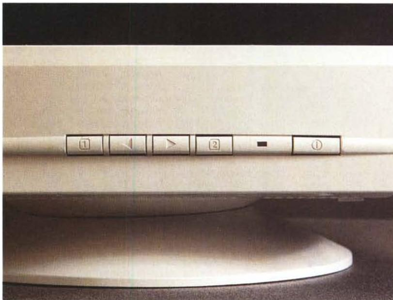
Il pannello di controllo con i tasti del menu On Screen. A destra sono visibili il led di stato ed il pulsante d'accensione.
