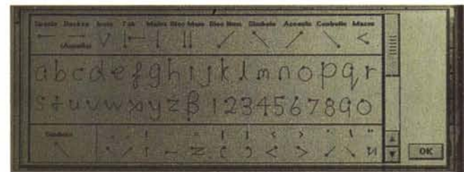
"Allegro" permette il riconoscimento della scrittura utilizzando lo stilo fornito a corredo con lo Psion 5. A destra la mappa dei caratteri, con il tragitto preimpostato.
