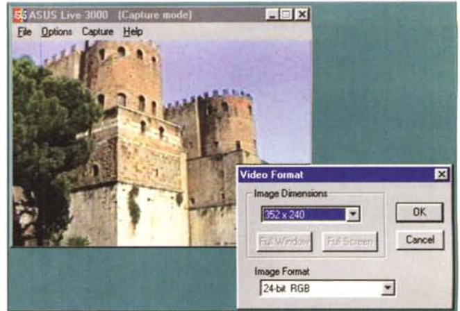
Il pannello Asus Live 3000 in fase di cattura. Oltre al single frame e ad un video, il modulo è in grado di catturare singoli frame in maniera continua. Con il requester attivo che vediamo in figura è sufficiente premere sul click per ottenere in rapida successione tutti i single frame che vorremo.
