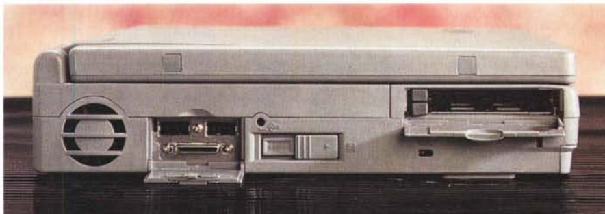
Sul lato sinistro la ventola di aerazione, l'interruttore, le due porte USB, per il drive esterno e la sede PCMCIA.
