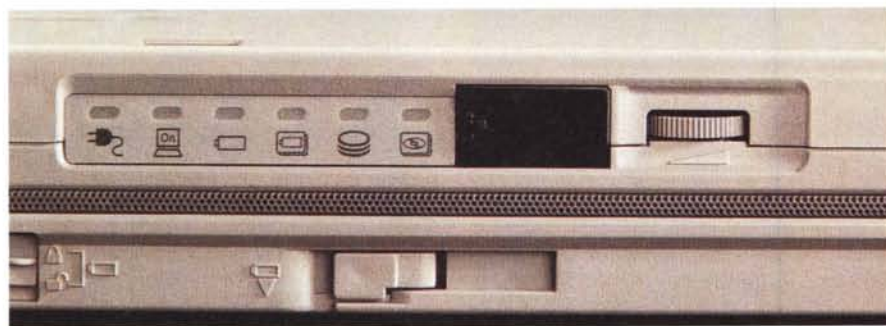
Modularità e massima espandibilità sono due caratteristiche chiave del portatile Toshiba. In basso il pannello anteriore con la regolazione del volume audio e la seconda porta IR.
