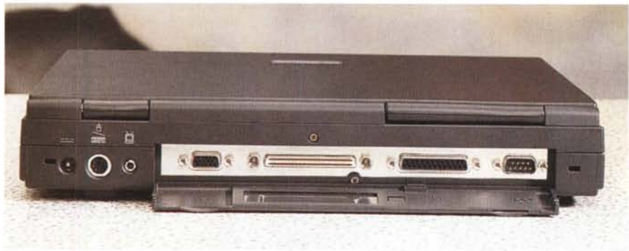
Vista posteriore. Da sinistra verso destra notiamo la connessione per l'alimentazione da rete, quella per mouse o tastiera esterni e la presa verso un TV-color. Dietro al solito sportellino infine le connessioni verso il monitor esterno, l'eventuale Docking Station, la stampante e, con una seriale a 9 pin, al limite un joystick.
