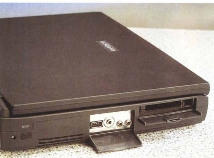
Vista laterale sinistra. Procedendo da sinistra verso destra, possiamo notare la presenza dell'adattatore IrDA ed a seguire, protette da uno sportellino, le connessioni USB e quindi quelle dedicate all'I/O del gruppo audio.
