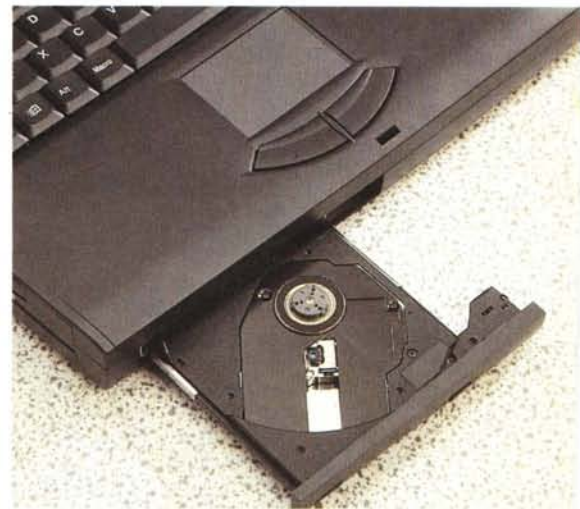
Vista anteriore. Il touchpad e, frontalmente, il CD-ROM 20X con il cestello aperto.
