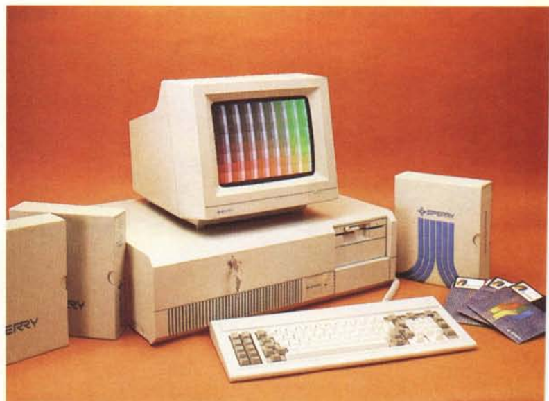
Lo Sperry PC/IT era un "compatibilone" basato su microprocessore Intel 286. Costava quasi dieci milioni, aveva mezzo mega di memoria e con un altro milioncino abbondante era in grado di portare la sua RAM al fantascientifico valore di un megabyte di memoria centrale!
