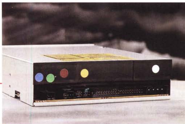
Visto da dietro, il lettore potrebbe sembrare uno tra i tanti. Notare il cavallotto rivestito in gomma verde con la comoda linguetta.
