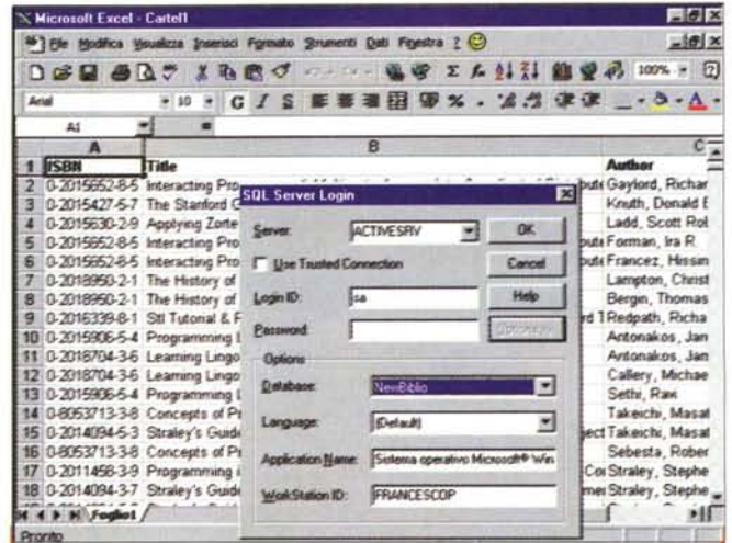
Figura 9 - MS Query 97 - A servizio di Excel. Qui vediamo, in un collage, sia il nostro foglio Excel riempito con i dati provenienti dall'MS Query sia la box che viene visualizzata quando si accede alla connessione NewBiblio. Una volta creata la query e scaricati i dati sul foglio sono attivabili, ad esempio attivando il quick menu sull'area con i dati, i comandi di Aggiornamento dei dati oppure di Modifica della query. In altre parole l'area con i dati rimane legata all'origine stessa dei dati. L'intera operazione di query si può parametrizzare e si può inglobare in una macro. In questo modo si riesce a creare una procedura generalizzata di interrogazione del database SQL, eseguibile totalmente da Excel.
