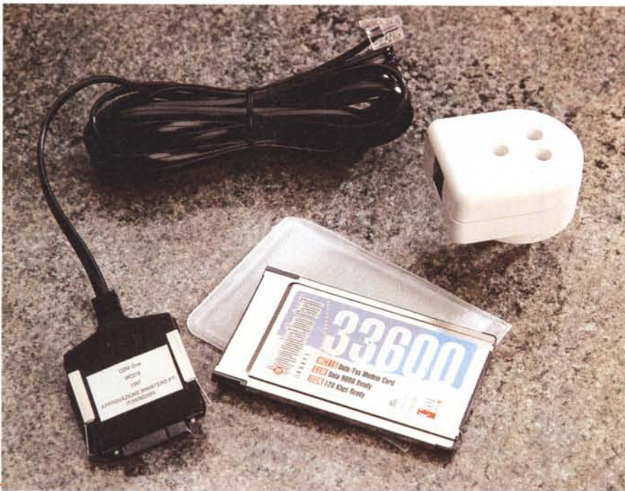
La scheda PCMCIA con il cavo modem/fax per il collegamento ad una linea analogica.
