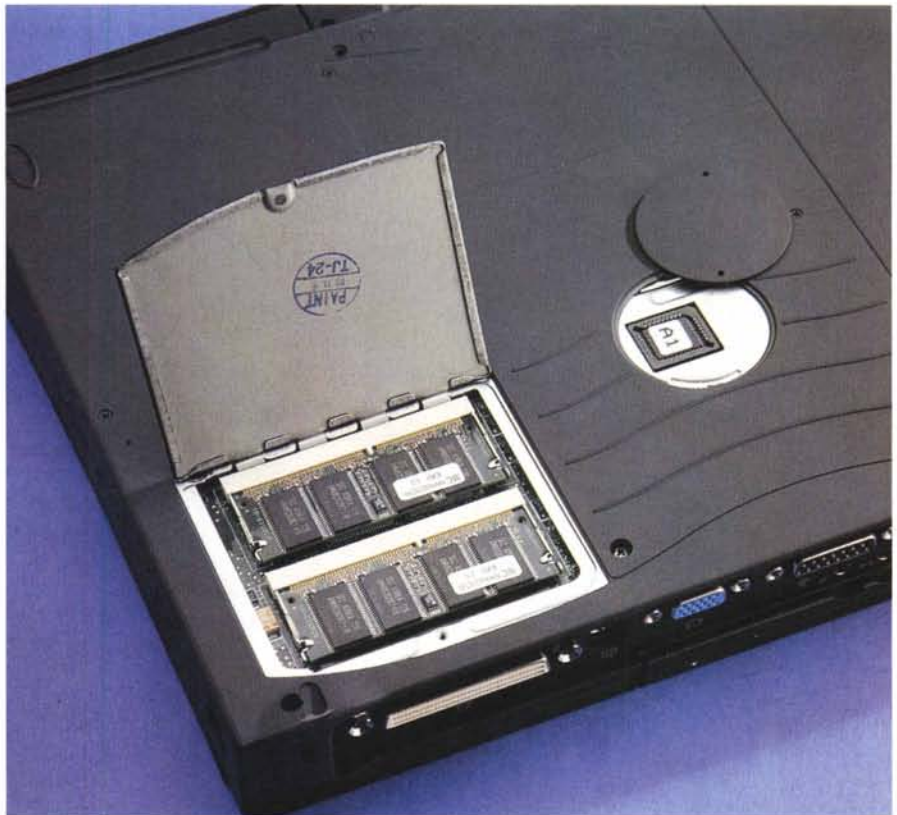
Due sportelli sul fondo della macchina permettono l'accesso alla RAM ed alla Flash-ROM del BIOS.
