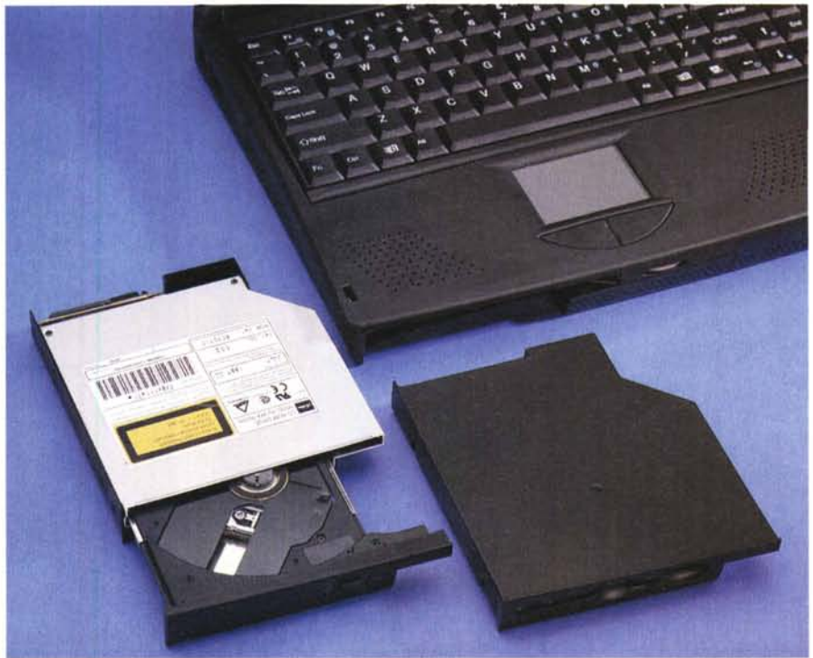
L'alloggiamento frontale può contenere il lettore di CD o quello per i floppy.
