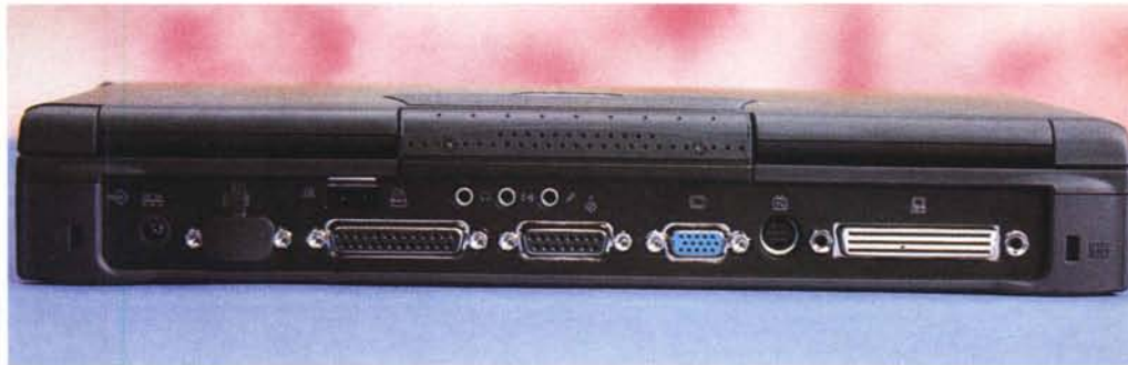
Il retro del GEO Millennium. La porta seriale è riparata da un tappo in gomma, a vista tutti gli altri connettori.
