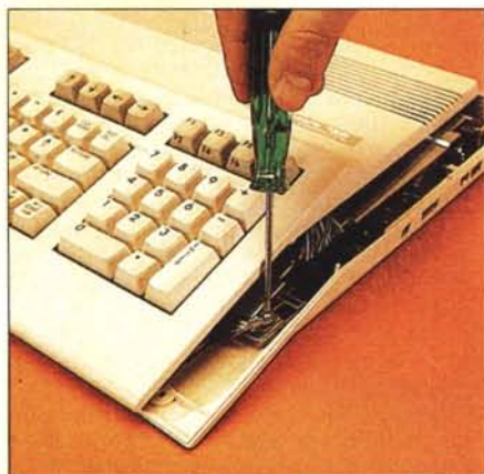
Sbloccaggio contatto di massa della tastiera.
