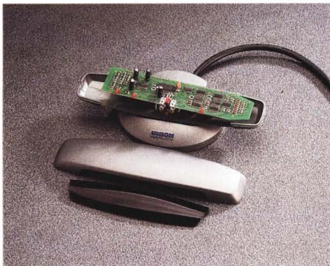
Due immagini dell'emettitore a raggi infrarossi aperto che incorpora anche la circuiteria di interfacciamento al computer. Tutta la tecnologia, interamente made in Italy, è protetta da numerosi brevetti internazionali.
