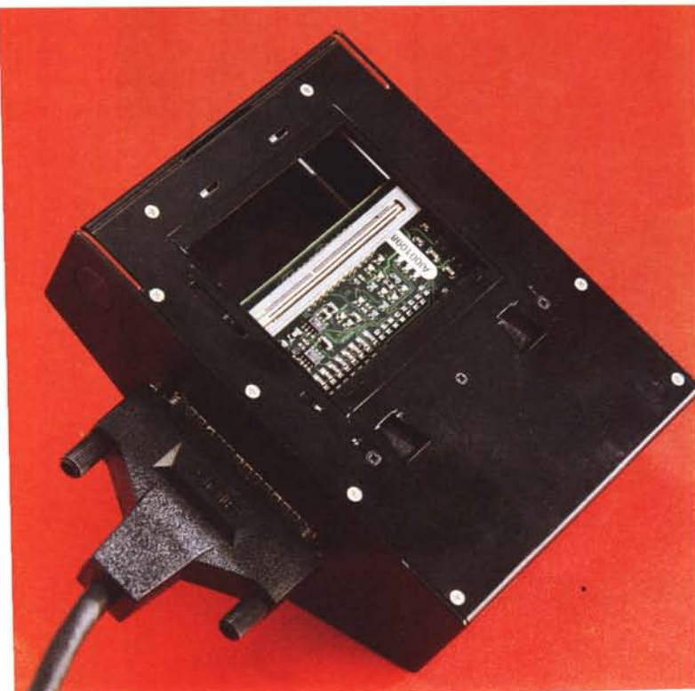
A sinistra il dorso digitale "lato esposizione" con la sua testina di scansione composta da un CCD trilineare da 3x7.000 pixel. In basso il PowerPhase, il suo alimentatore, il cavo di collegamento e l'immane camera Hasselblad.
