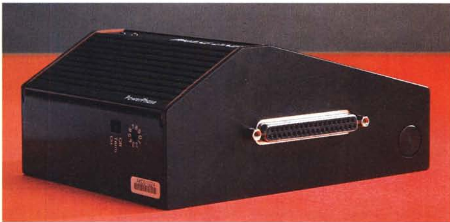
Il Phase One PowerPhase non è che un "semplice scatolotto nero" (costa, però, quasi sessanta milioni!) da applicare alle fotocamere professionali. Sul lato la porta SCSI per il collegamento al computer.
