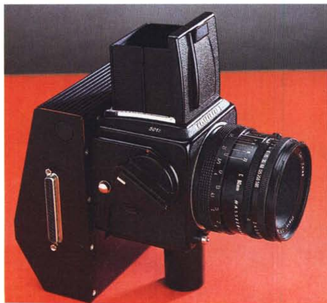
Il dorso digitale PowerPhase a sinistra installato su un'Hasselblad di "fascia bassa", la 501C; qui in alto sull'interessantissimo FlexBody.
