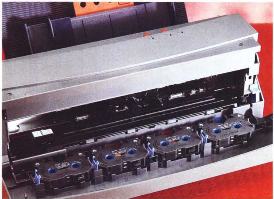
Le quattro cartucce (nero, cyan, magenta e giallo) sono alloggiare dietro lo sportello anteriore. Di qui una alla volta sono prelevate e posizionate sul gruppo di stampa.
